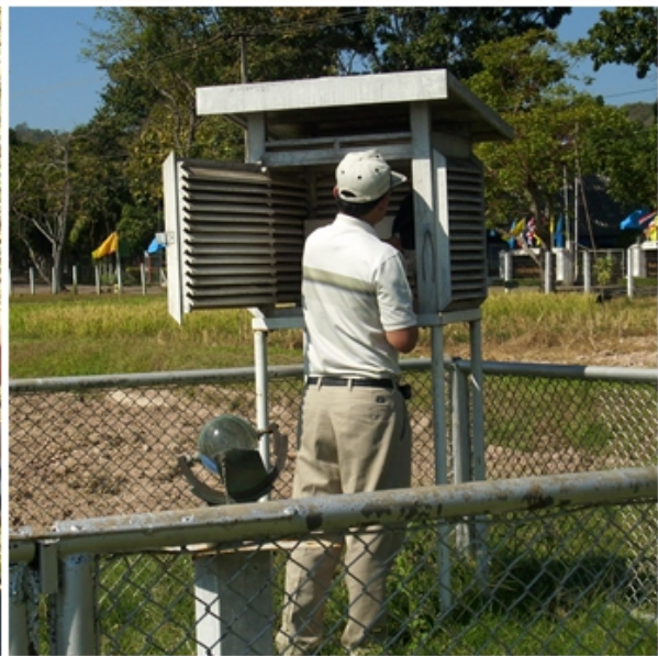
ภาพผนวกที่ ค-3 แสดงการจัดเตรียมเครื่องมือ hookgauge เพื่อวัดระดับน้ำในถัง lysimeter และเครื่องมือ อุตุนิยมวิทยา
