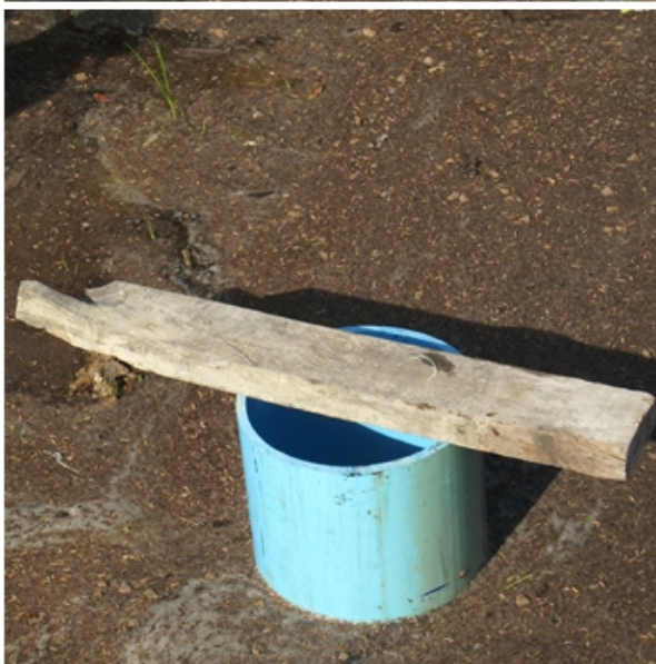
ภาพผนวกที่ ค-6 แสดงการติดตั้งท่อวัดการซึมของน้ำลงสู่ระดับดินชั้นล่าง (percolation)
