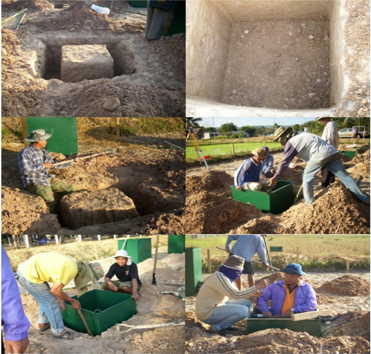
ภาพผนวกที่ ค-1 แสดงการติดตั้งถัง Lysimeter เพื่อวัดค่าการใช้น้ำของข้าวเหนียวพันธุ์สกลนคร
