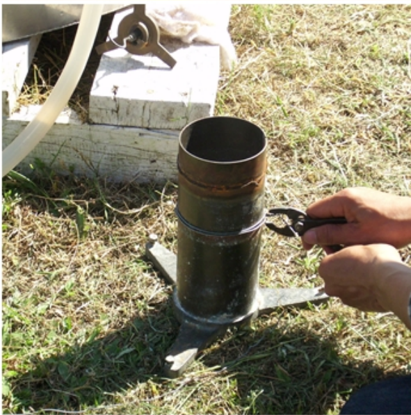
ภาพผนวกที่ ค-3 แสดงการจัดเตรียมเครื่องมือ hookgauge เพื่อวัดระดับน้ำในถัง lysimeter และเครื่องมือ อุตุนิยมวิทยา
