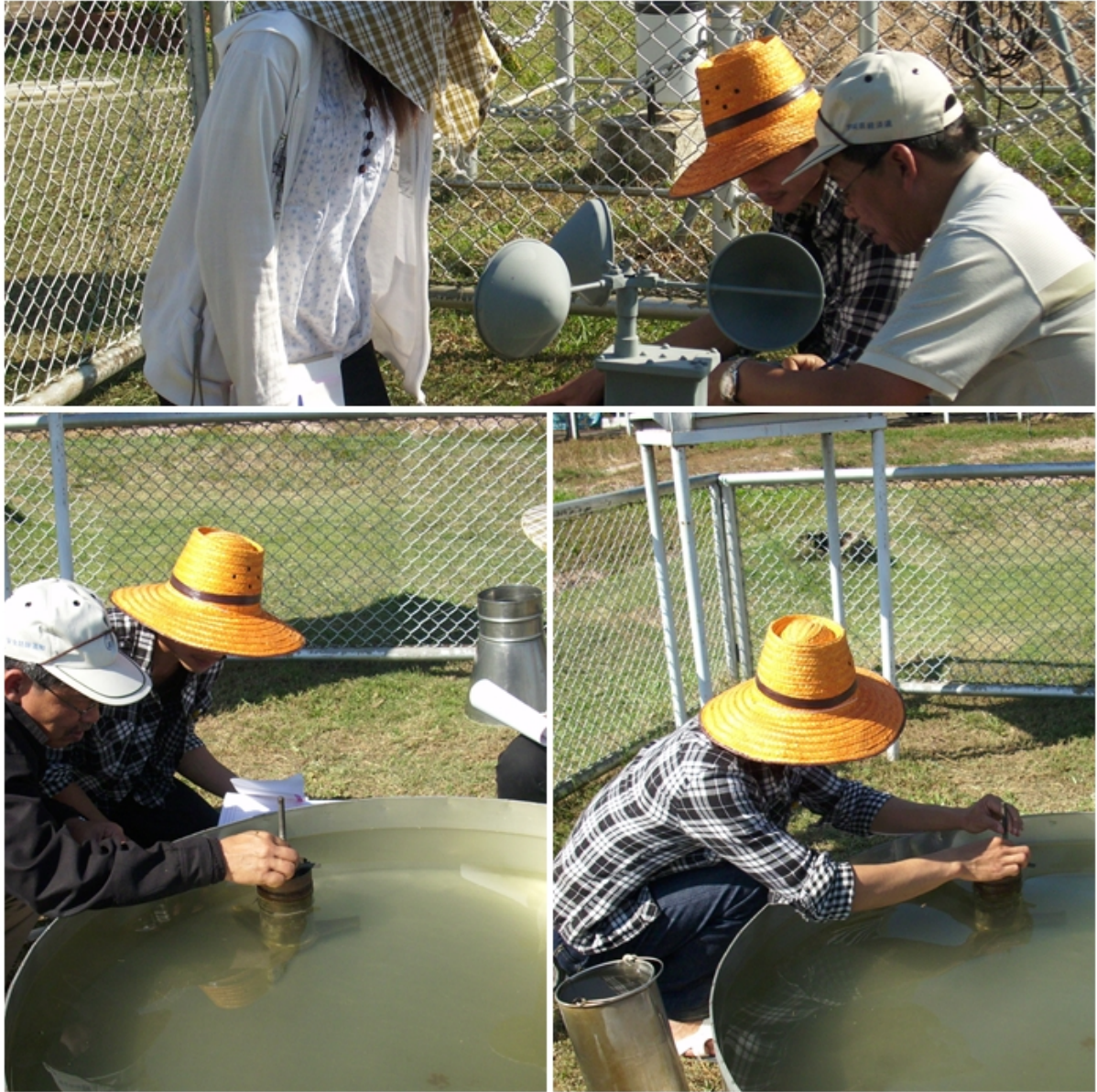
ภาพผนวกที่ ค-3 แสดงการเก็บข้อมูลการระเหยของน้ำจากถาดวัดการระเหยแบบ American Class A Pan
