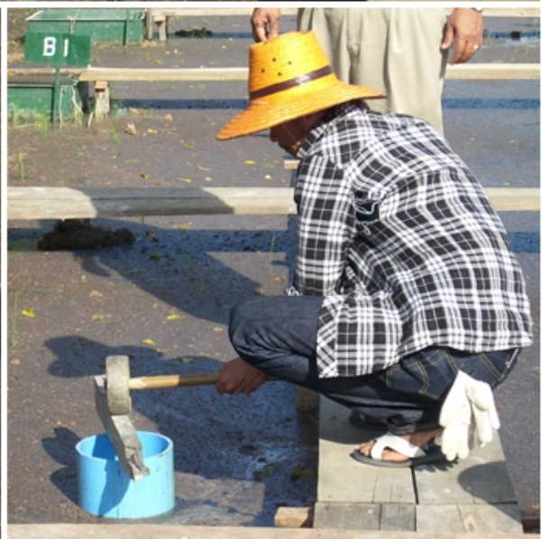
ภาพผนวกที่ ค-6 แสดงการติดตั้งท่อวัดการซึมของน้ำลงสู่ระดับดินชั้นล่าง (percolation)
